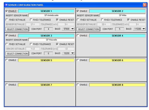
Damit von einem Sensor Daten aufgezeichnet werden können, muss dieser mit "ENABLE" aktiviert werden.
