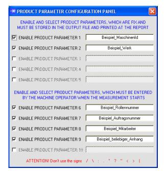
Es stehen 5 Parameter zur Verfügung, die individuell eingegeben werden können. Die Daten sind fix und werden beim Abspeichern, sofern "Enabled", im File abgelegt bzw. mit ausgedruckt.
